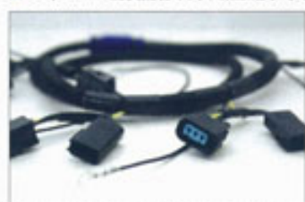
▲ 需要接駁原裝點火裝置的轉插，將電壓加強至點火器身上。
