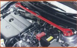
■ 剛性十分強勁的頭頂Bar,用上環結合鋼鐵製成,可為車架 作剛性補強,直接提高轉向的指各性能,提高拐彎操控。
