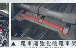
▲ 尾車廂強化的尾車架Bar，能增強車尾的剛性。
