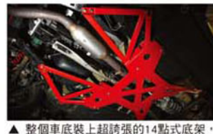
▲ 整個車底裝上超誇張的14點式底架，遍及整個車底，直接令MX-5先天無頂的車架設計及底擔作出最全面的強化。
