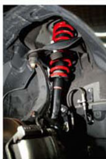
▲ 為了保留原裝行走舒適性，更又想追求車身造型美感，所以只更換了AutoExe Low Down彈弓。
