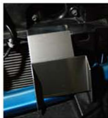
▲整個碳纖風箱附加了一個鋁合金導風板，直接安裝在泵把後方位置，可將更多的空氣導入風箱之內。
