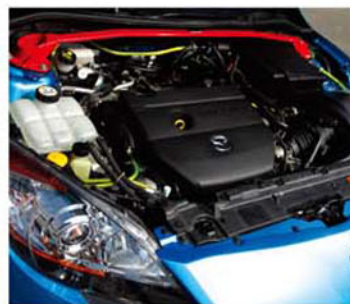
▲加裝上AutoExe碳纖風箱系統，內置一個K&N高流量風隔，直接加強引擎吸氣效率。同時更加裝上SplitFire D Spark Max電子點火增強器。
