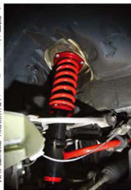
▲ 採用上AutoExe Type A高性能絞牙避震機系統，設有2段軟硬調節，具有出色的行走舒適性。
