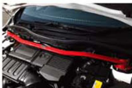
▲ 為了增強車架的剛性追加了一條AutoExe頭頂Bar。
