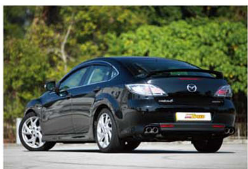
▲ 此Mazda 6已更換上中至尾燕子式設計的四出不銹鋼尾喉。
