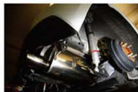
▲ 全不銹鋼設計的中至尾AutoExe排氣喉，有著沉厚的排氣聲浪。
