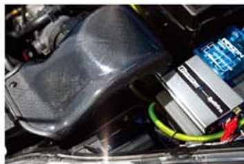
▲加裝上AutoExe碳纖風箱系統，內置一個K&N高流量風隔，直接加強引擎吸氣效率。同時更加裝上SplitFire D Spark Max電子點火增強器。
