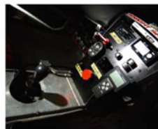
▲ 使用上Sequential波箱，更配搭Power FC行車電腦。
