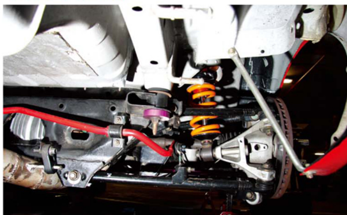
▲ 懸掛系統已換入Knight Sports改化部件，避震機方面選用上日本名廠Aragosta頂級絞牙避震機。
