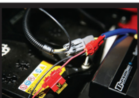
▲ D Spark Max設有Fuse斷電器，安全可靠。
