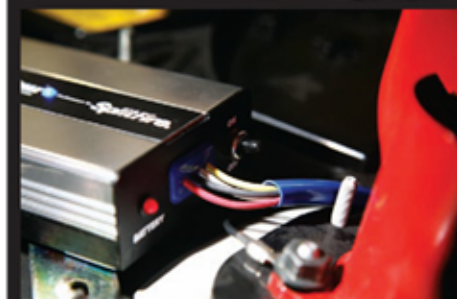
▲ D Spark Max體積細小，易於收藏在引擎箱內，設有斷路開關，即使車輛電子系統出現故障，D Spark Max亦會馬上跳到原廠設定，不會影響任何電子系統。
