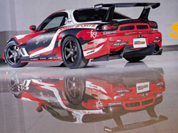
▲ 車尾加裝了一個Knight Sports車底擾流導風板，有助提升高速行車的穩定性。
